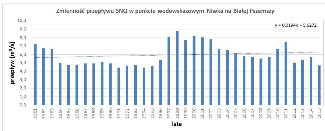
Rys. 30 Zmienność przepływu minimalnego w punkcie wodowskazowym Niwka na Białej Przemszy wraz z linią trendu
